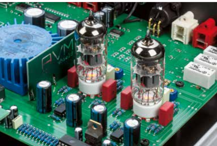
Auch im CD-Player wurde in Sachen „lokaler Spannungsversorgung“ beträchtlicher Aufwand betrieben, was nicht zuletzt die Anzahl der Trafos zeigt
