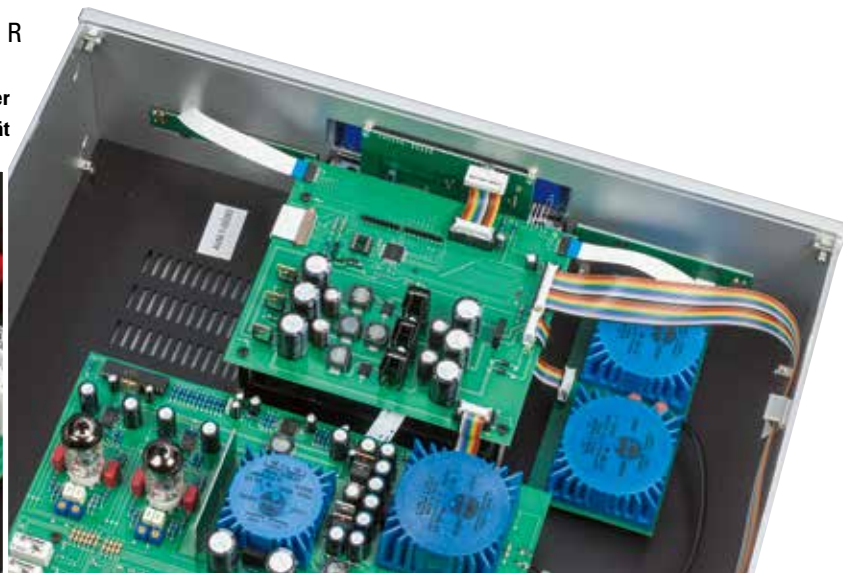
Auch im CD-Player wurde in Sachen „lokaler Spannungsversorgung“ beträchtlicher Aufwand betrieben, was nicht zuletzt die Anzahl der Trafos zeigt
